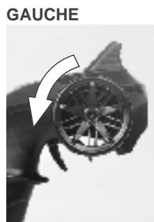
2) Le tourner sur la gauche pour permettre au véhicule de tourner à gauche
