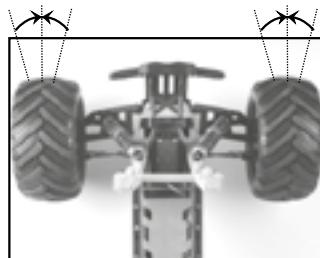
Placer le véhicule sur un support pour que les roues ne touchent plus le sol, puis ajuster le Trim afin d'aligner les roues avants
