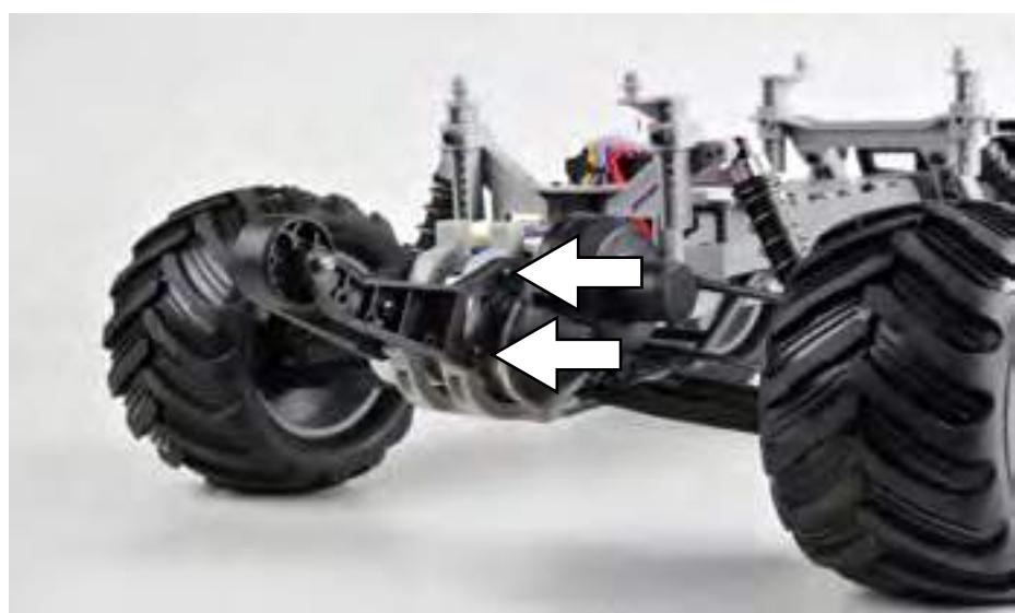
Utilizar los tornillos incluidos con su coche para montar la barra trasera
