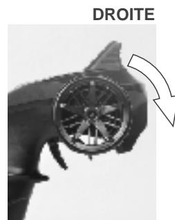
2) Le tourner sur la droite pour permettre au véhicule de tourner à droite
